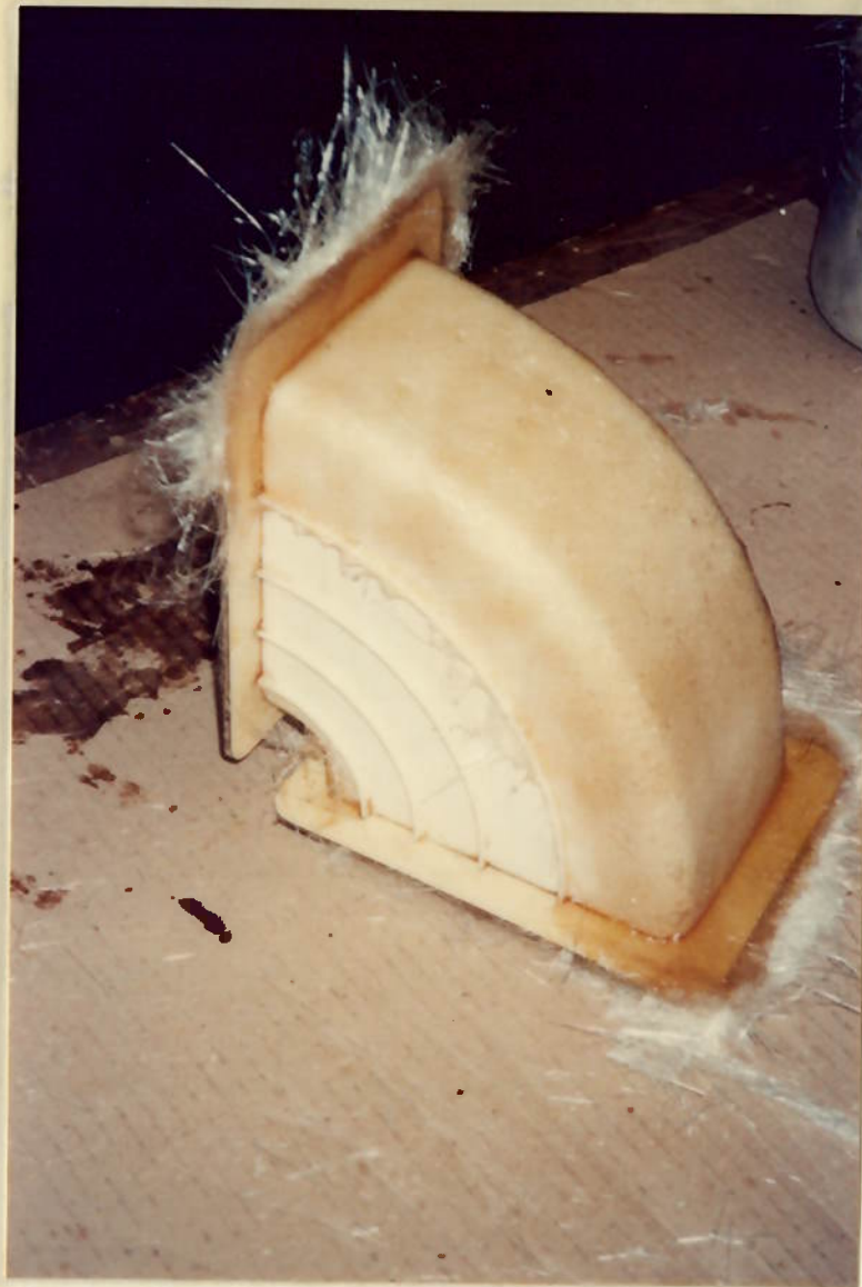
foto 3: detalhe de recobrimento de um molde com fibra de vidro.
